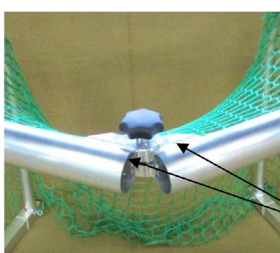
Lattenprofil 180 Grad ausklappen, sodass es durchgehend gerade verläuft. Handrad wieder anziehen.
